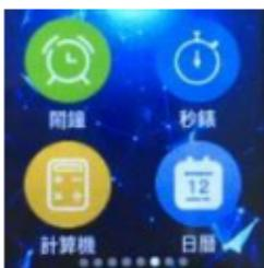
**(17) 鬧鐘**：鬧鐘提醒。由手機 APP 的[首頁]→[裝置鬧鈴]來設定鬧鐘，可設定重複一次或每天、星期幾，總共可設定 3 組鬧鐘時間，手錶立即同步。
