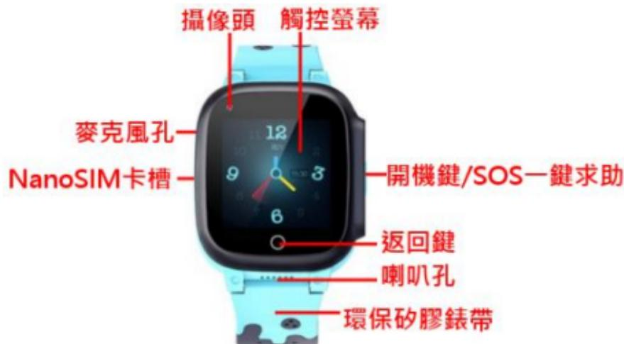
1. Nano Sim 卡槽：請以 **Nano Sim** 卡插入，手錶請先關機後再插 **Nano Sim** 卡。
