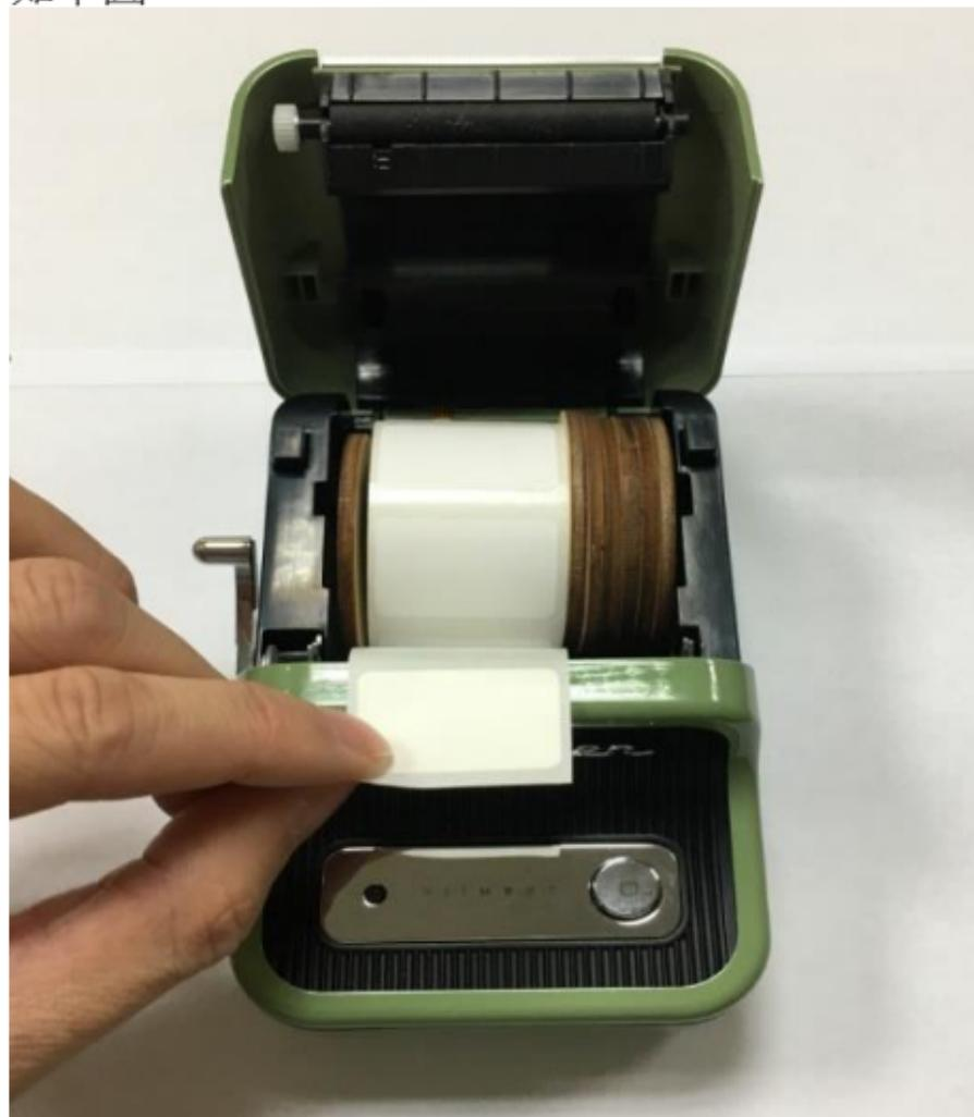
4. 蓋上紙倉上蓋後，印標機長按電源鍵開機，再將手機上的 APP(精臣雲打印)去連接印標機，即可列印標籤紙，成功。如下圖。
